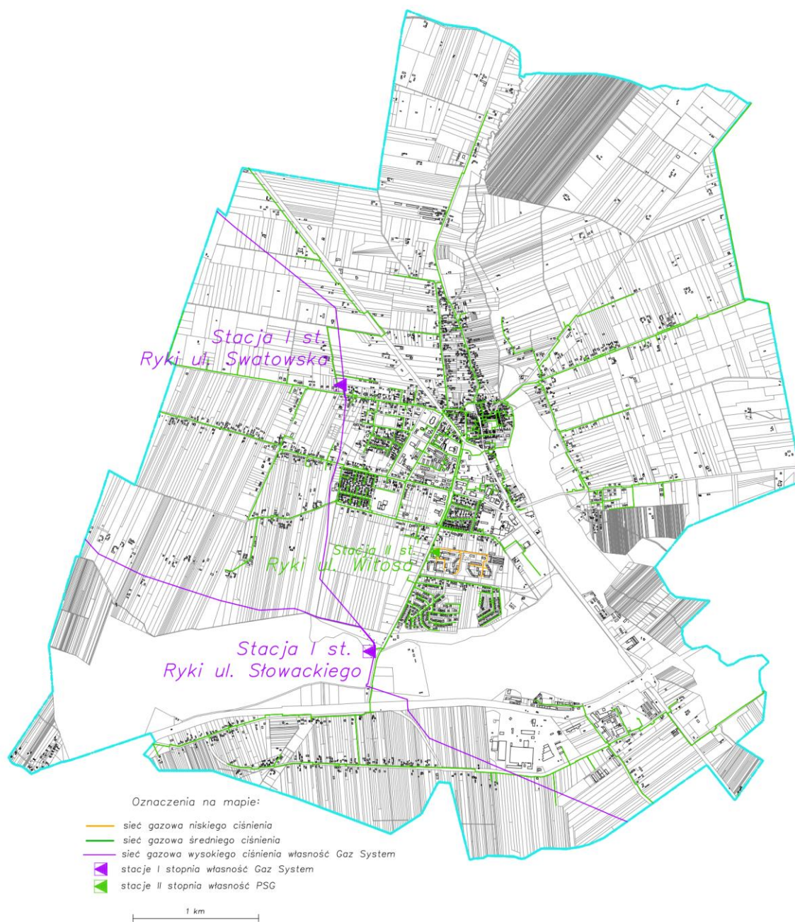
Rysunek 25 Sieć gazownicza na terenie miasta Ryki (źródło: Polska Spółka Gazownictwa sp. z o.o.)
